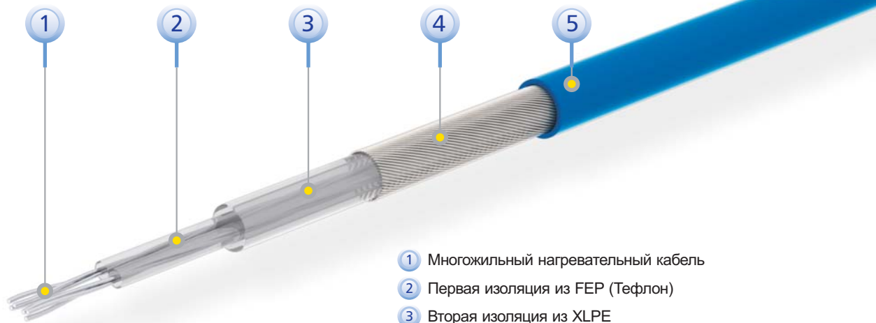
Структура нагревательного кабеля нагревательного мата ELEKTRA MD
